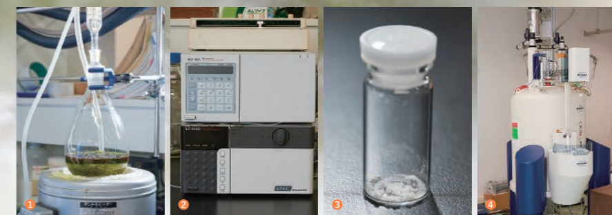
構造未知化合物の構造決定プロセス ①エタノールで抽出濃縮エキスを調整 ②クロマトグラフィーで分離 ③単離された物質 (白色粉末) ④核磁気共鳴 (NMR) スペクトル測定装置による構造解析
