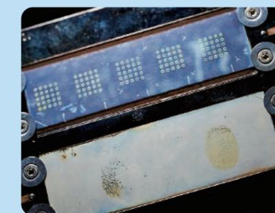
酸化亜鉛ナノワイヤプレート (上は血中薬物分析用のマルチウェルプレート、下は指先での健康診断用のプレート)
