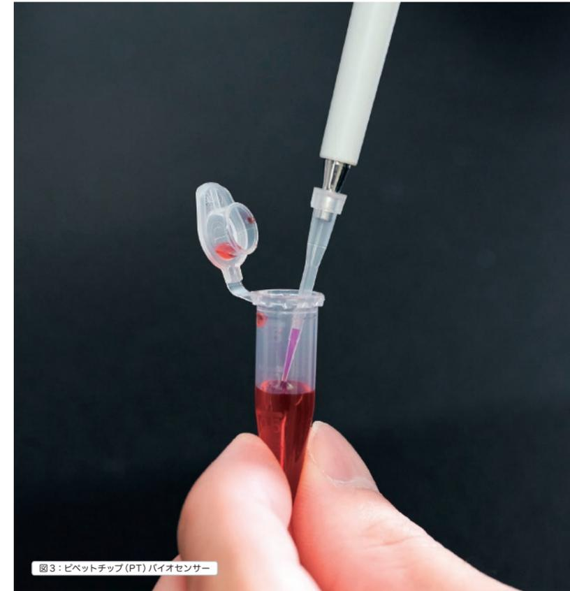
図3: ピペットチップ (PT) バイオセンサー
